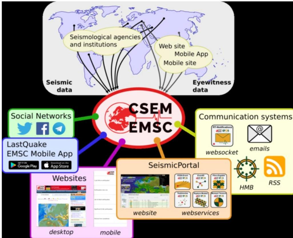
**FIGURE 1** : SCHEMATIC VIEW OF DATA COLLECTION AND DISTRIBUTION AT EMSC
